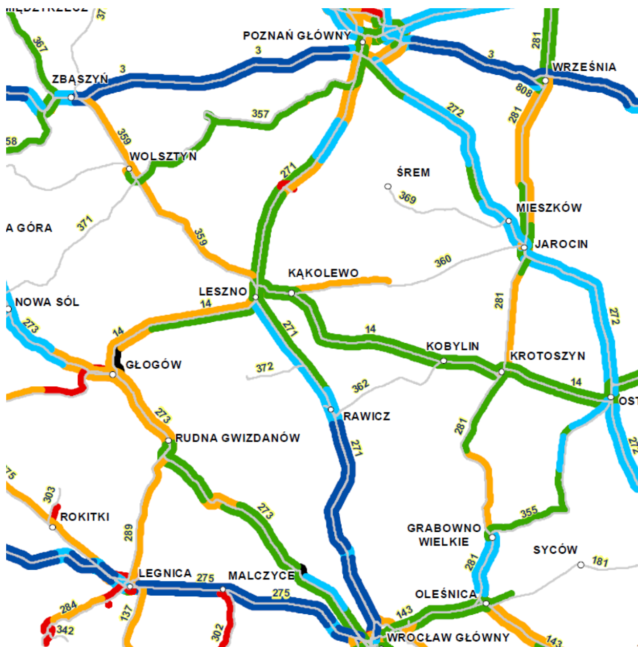
Rysunek 19 Maksymalne prędkości rozkładowe na eksploatowanych liniach kolejowych w okolicach miasta Leszna [źródło: http://www.plk-sa.pl/biuro-prasowe/mapy/ ]
