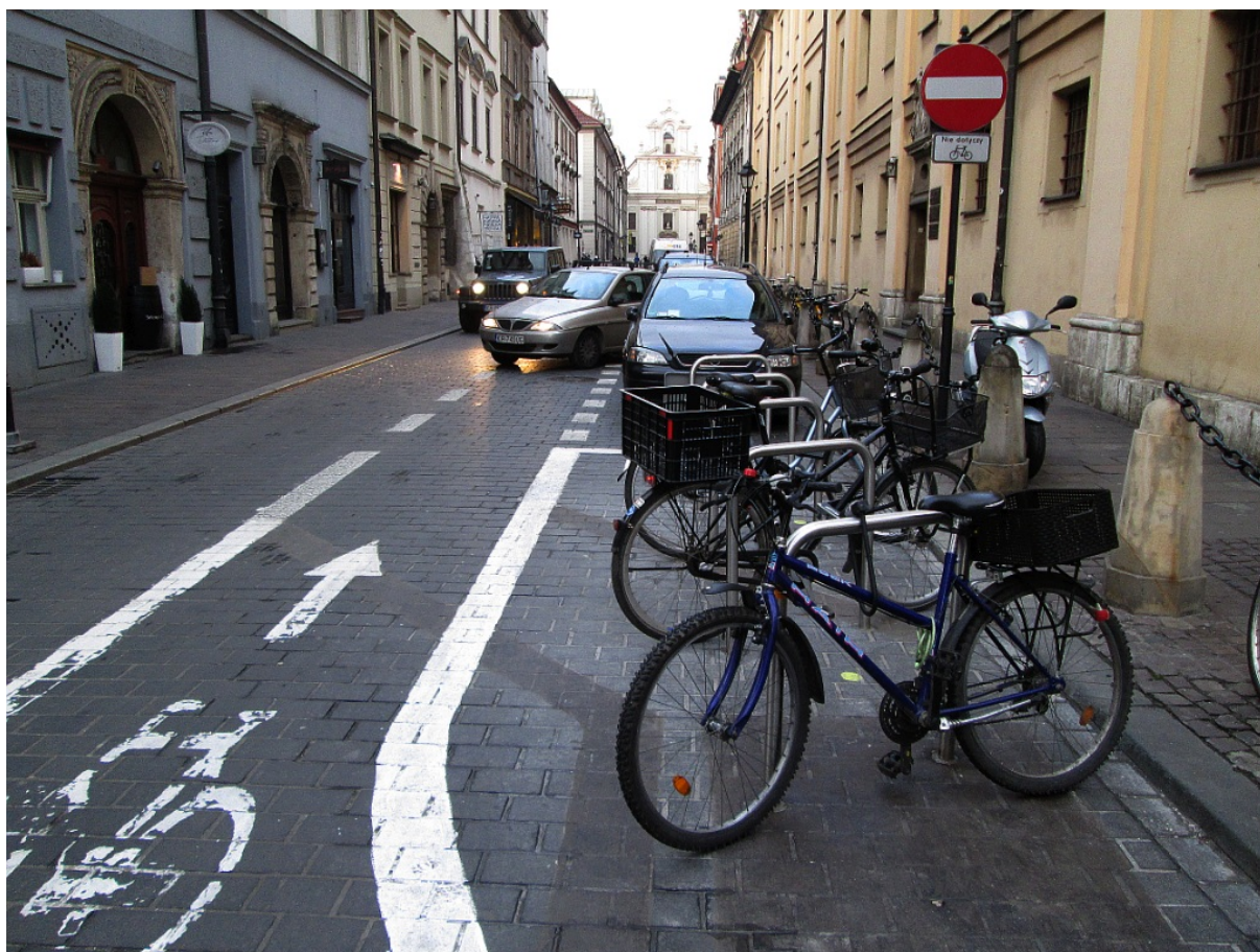
Fot. 14. Stojaki rowerowe zlokalizowane na jezdni w obrębie skrzyżowania. Poprawia to widoczność wzajemną i eliminuje ryzyko nieprawidłowego parkowania. Ul. św. Jana, Kraków.
