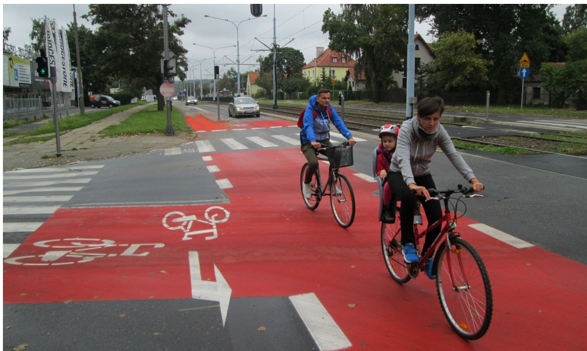
Fot. 9. Śluza typu 2, Gdańsk, ul. Wojska Polskiego. W głębi widoczna na wlocie śluza klasyczna, typu 1. Uwaga: zdjęcie przedstawia rozwiązanie eksperymentalne (rok 2013). W niniejszych standardach proponuje się nieco inne oznakowanie poziome śluzy typu 2, zgodne z przepisami po nowelizacji z 2015 roku (Dz. U. z 2015 r. poz. 1314).
