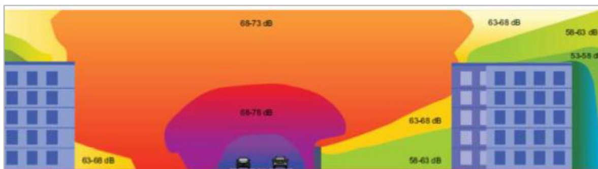
Schemat 2. Przykład propagacji hałasu drogowego (10 000 przejazdów/dzień ze średnią prędkością 50 km/h) w sąsiedztwie zabudowy o wys. 20 m - zasięg hałasu przy obecności ekranu o wys. 3 m (strona prawa) oraz bez ekranu (strona lewa)
