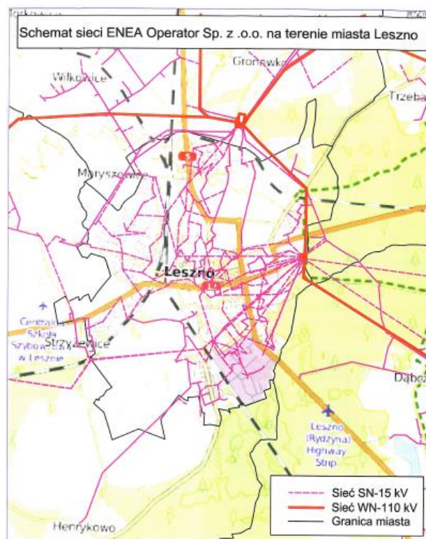
Rysunek 23 Schemat sieci ENEA Operator Sp. z o. o. na terenie miasta Leszno [źródło: ENEA Operator Sp. z o. o.]
