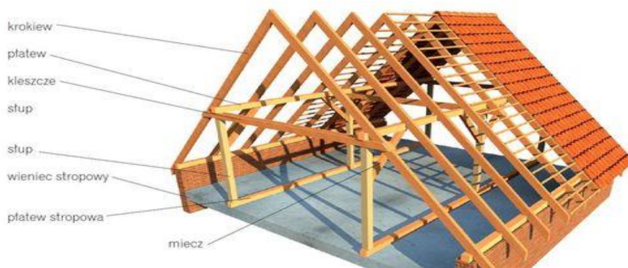
Rys.7. Przykładowy sposób wykonania więźby dachowej płatwiowo-kleszczowej.
