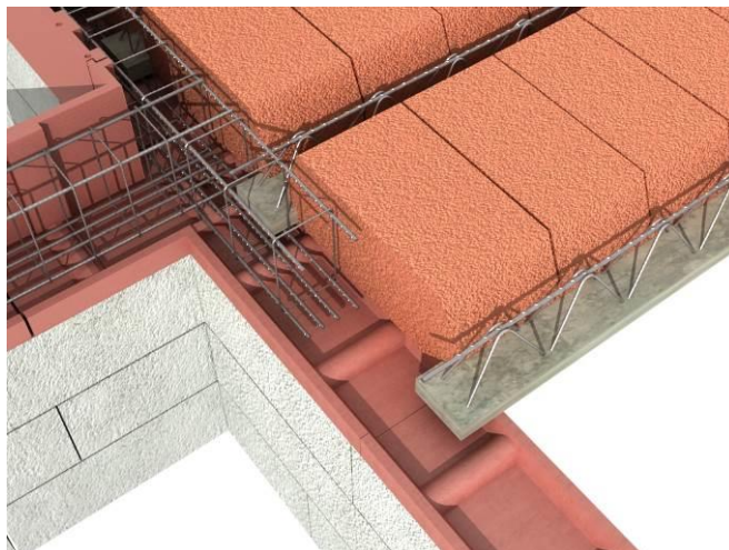
Rys. 5. Wykonanie wieńców.
