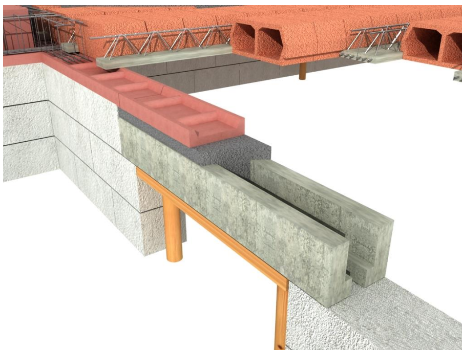
Rys. 12. Technologia obsadzenia nadproży prefabrykowanych L19.
