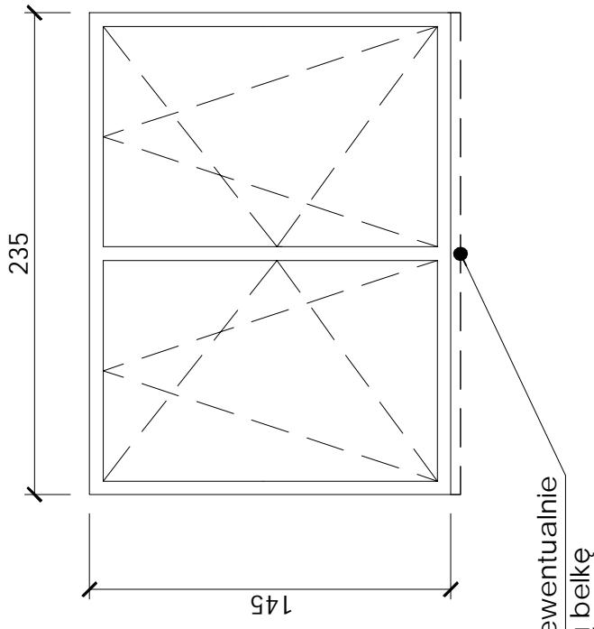
Okna z kształtowników z nieplastykowanego PCV, 5-komorowych, koloru białego, wzmacnianych stalowymi oczynkowanymi kształtownikami na całym obwodzie ram ościeżnic i skrzydeł.
