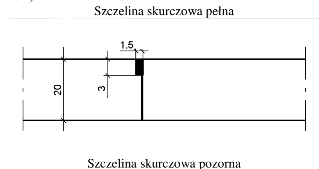
Rys. 1.1. Przykłady konstrukcji szczelin w podbudowie z betonu cementowego (wymiary w cm)
